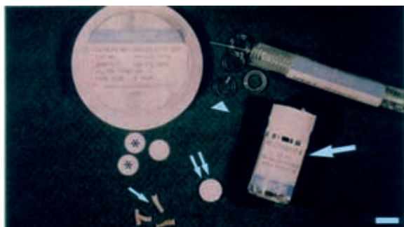
Figura 6. (a) Las células se implantaron en cámaras de iDBM (flecha), o en cámaras de difusión (doble flecha) formadas por un anillo plástico (cabeza de flecha) al que por ambos lados se le pegan (adhesivo, flecha larga) sendos filtros de 0,45\ \mu\text{m} de tamaño de poro (asteriscos). La implantación se realizó bajo la piel de la espalda de ratas Fischer-344 machos de 28 semanas de edad (b, c). Barra, 1 cm.
